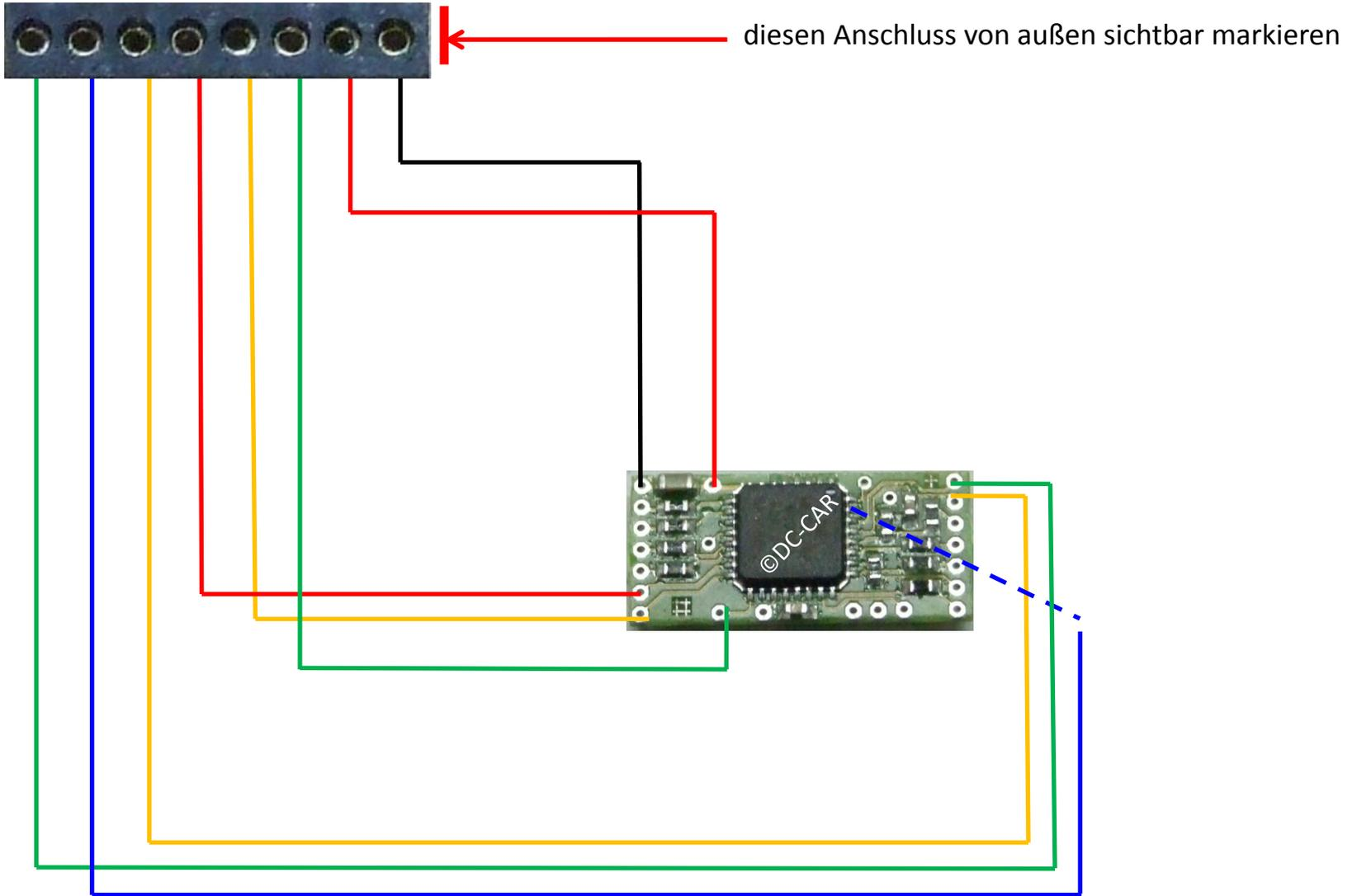
Bei Bedarf kann PIN 7 der Updatebuchse mit Pin 31 des Prozessors verbunden werden.
