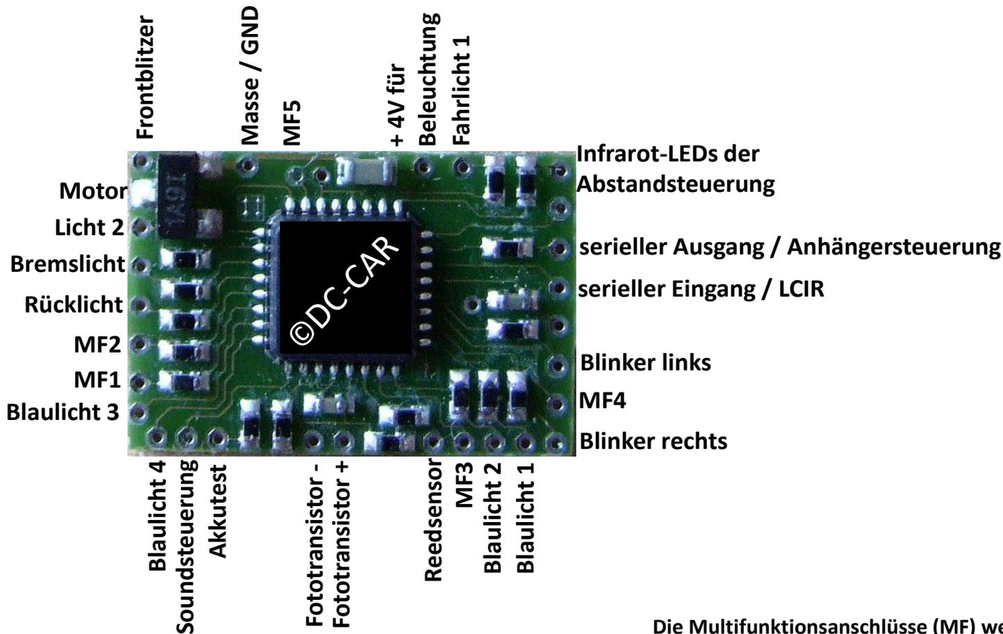
Folgende Ausgänge müssen bei Anschluss von LEDs mit externen Vorwiderständen versehen werden:
