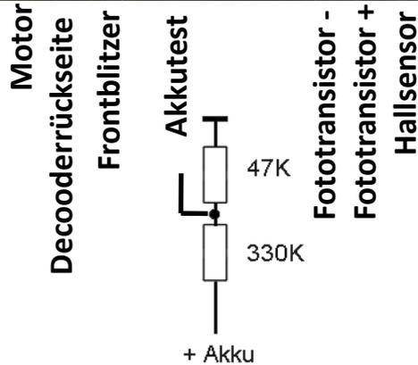
Folgende Ausgänge müssen bei Anschluss von LEDs mit externen Vorwiderständen versehen werden:
