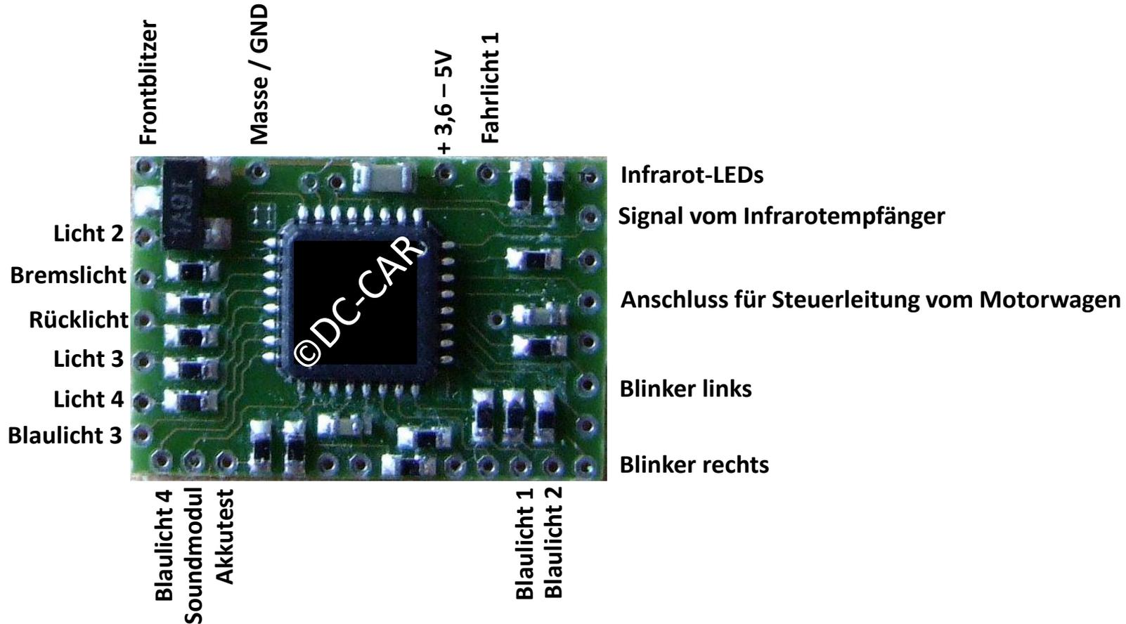
Folgende Ausgänge müssen bei Anschluss von LEDs mit externen Vorwiderständen versehen werden:
