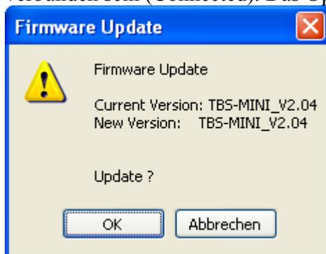
Wenn die Firmware gelöscht wurde oder beschädigt ist muss das Update manuell gestartet werden. Dazu muss das Soundmodul zuerst ausgeschaltet werden, dann auf OK klicken und das Modul sofort danach einschalten. Der richtige COM-Anschluss muss dazu ausgewählt sein.
